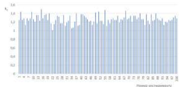
Рис. 6. Варіація коефіцієнта заповнення салону автобуса марки MAN R07 Lions Coach у серії експериментальних спостережень
