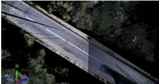
Рис. 7. Вплив сонячного освітлення на колоризацію хмари точок
