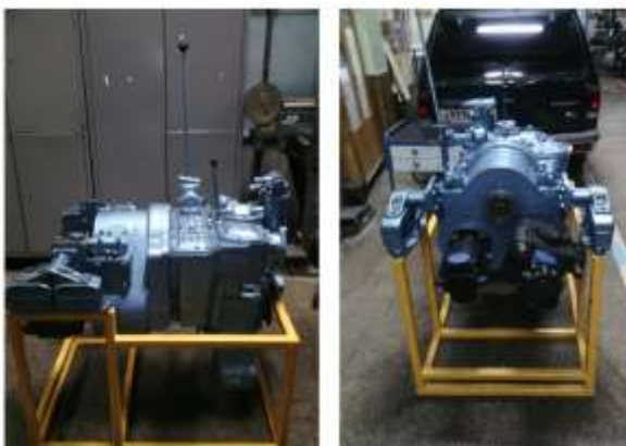
Рис. 7. Двопотокова об'ємно-гідромеханічна трансмісія колісного трактора ХТЗ
