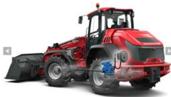
Рис. 3. Навантажувач Weideman-9080 з трансмісією на базі аксіальнопоршневого регульованого гідромотора, редуктора й двох карданих валів
