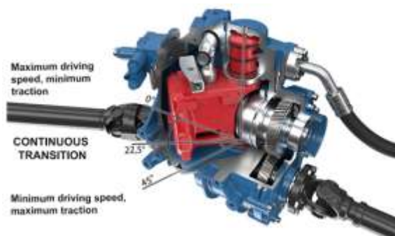
Рис. 4. Аксіальнопоршневий гідромотор із регульованим робочим об'ємом, редуктор і карданні вали трансмісії навантажувача Weideman-9080
