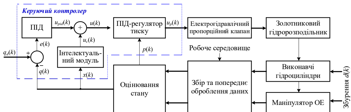
Рис. 3. Структура підсистеми реалізації керування маніпулятором ОЕ
