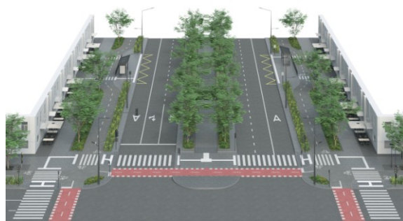
Рис. 2. Запропонована схема проєктування дороги загальноміського значення відповідно до Довідника з відбудови міст [2]
