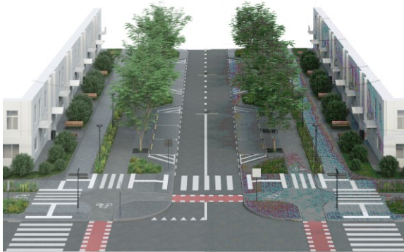
Рис. 3. Запропонована схема проєктування житлової широкої вулиці відповідно до Довідника з відбудови міст [2]
