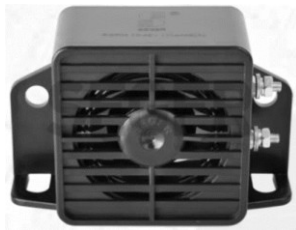
Рис. 7. Звукова сигналізація руху
