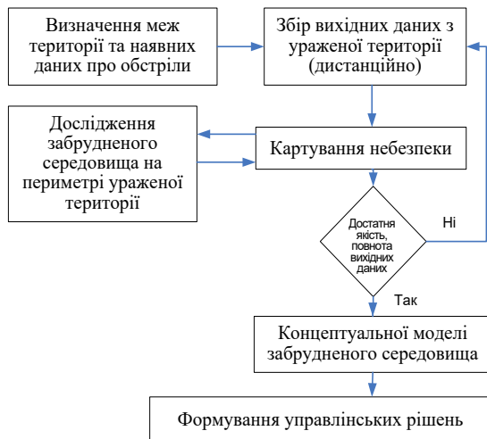
Рис. 1. Алгоритм геопросторового профілювання території можливого радіаційного забруднення внаслідок ракетно-артилерійських уражень
