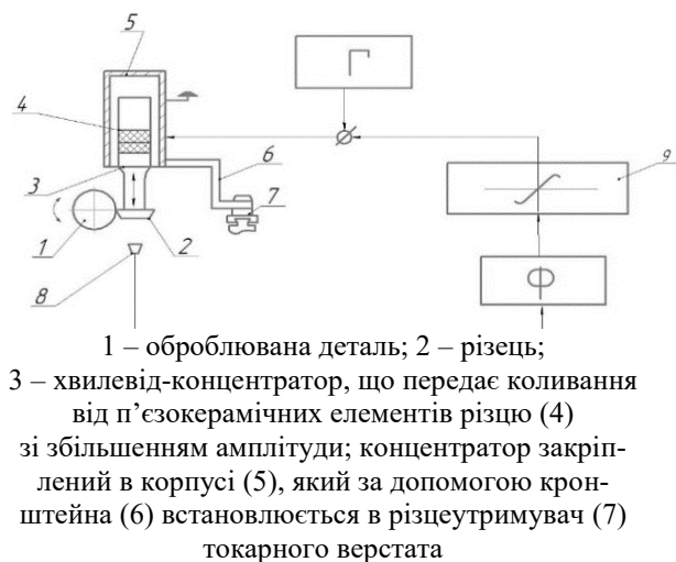
Рис. 4. Авторезонансний пристрій для ультразвукового різання
