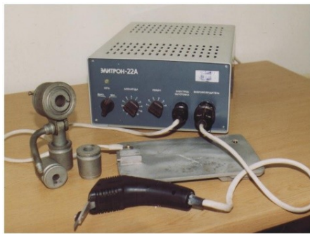
Рис. 1. Установка «Елітрон-22А» для проведення ЕІЛ
