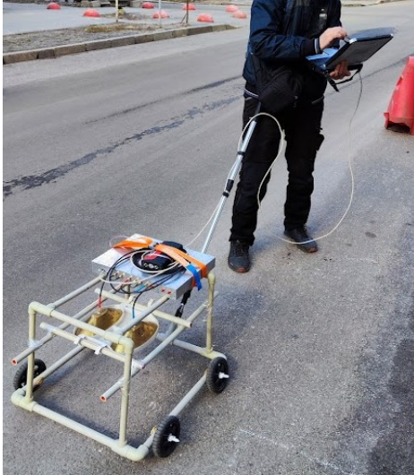
Рис. 1. Георадарний комплекс ОДЯГ-1
