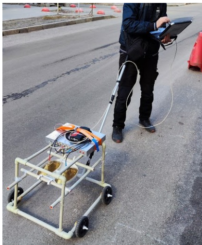
Рис. 1. Георадарний комплекс ОДЯГ-1
