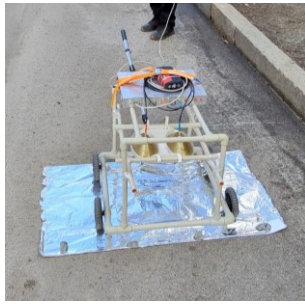
Рис. 5. Калібрування з використанням листа металу
