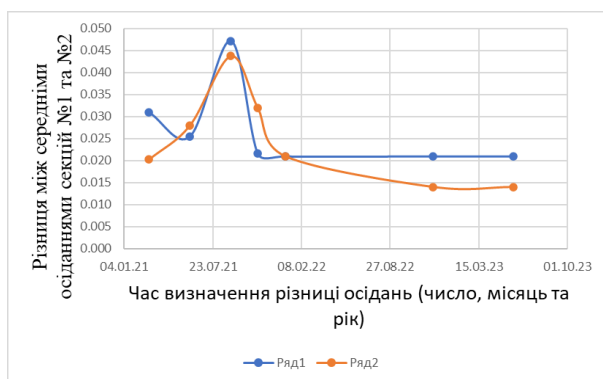
Рис. 10. Різниця між осіданнями першого та другого відсіків. Ряд 1 — теорія; ряд 2 — експеримент (Примітка. Рис. 10 необхідно читати разом з рис. 9.)
