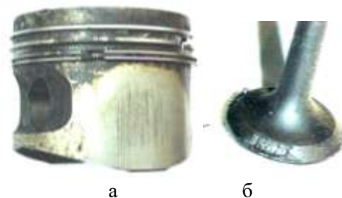
Рис. 5. Результати виявлених під час експерименту несправностей ДВЗ: а – зношування поршневих кілець і поршневих канавок, збільшення або зменшення зазора між кільцем і поршневою канавкою за висотою перетину; б – деформація стрижня клапана або прогар тарілки клапана
