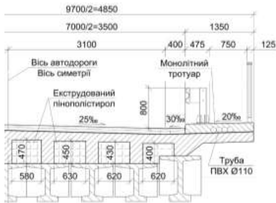
Рис. 12. Поперечний переріз мосту з полегшеною плитою
