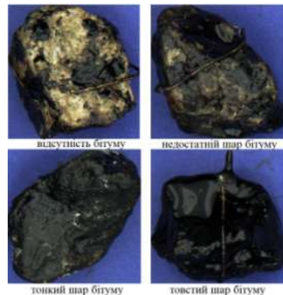
Рис. 17. Тип покриття зерна кам'яного матеріалу [20]
