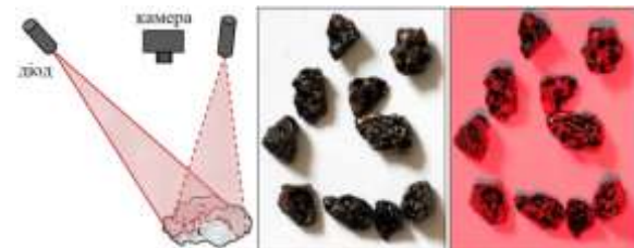
Рис. 6. Розташування освітлювальних елементів і зображення зразка, отримане в умовах денного світла (ліворуч) та освітлене лазерним світлодіодом (праворуч) [6]
