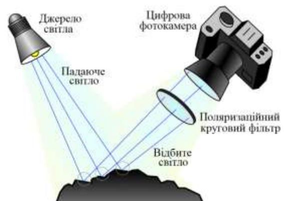
Рис. 3. Схема отримання зображення зразка з використанням поляризаційного фільтра [9]
