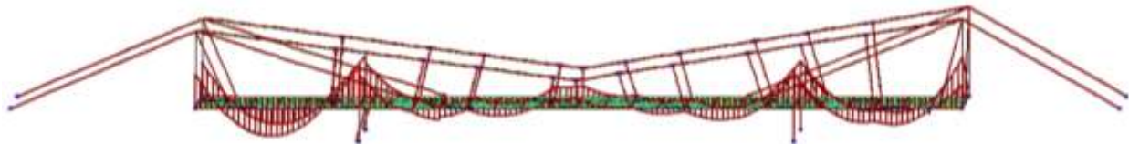
Рис. 2. Скінчено-елементна модель пішохідного підвісного мосту
