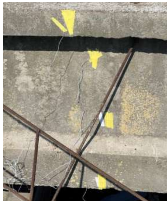
Рис. 3. Сенсори термопар закріплені на поверхні балки
