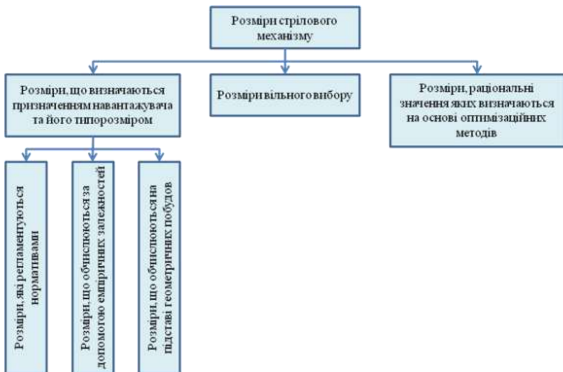
Рис. 4. Класифікація розмірів стрілового механізму
