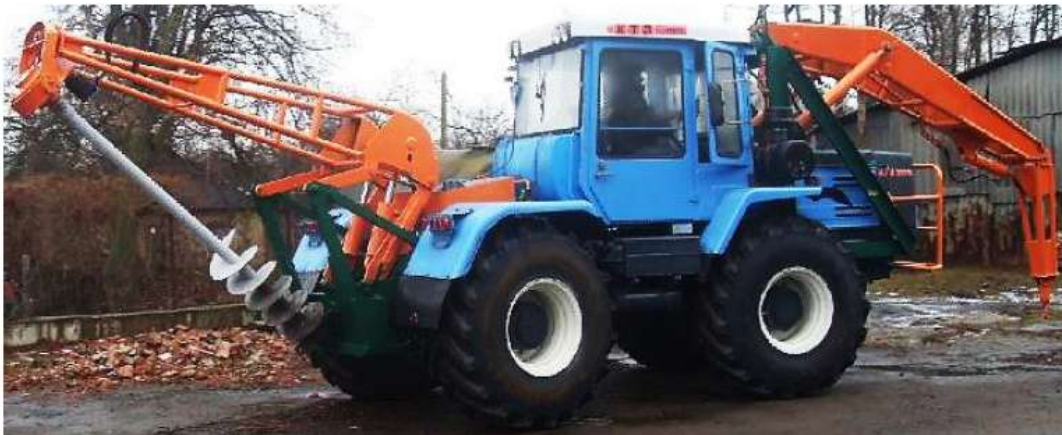
Рис. 1. Машина БКМ-2М на базі трактора ХТЗ-17221 з гідравлічним приводом обертання бура
