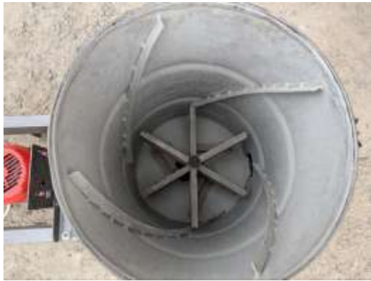
Рис. 2 – Робочі елементи бетонозмішувача примусової дії
