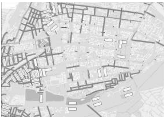
Рис.14. Розподіл середньодобової швидкості руху транспортних потоків у системі ІТ у моделі мережі міста Кривий Ріг (фрагмент)
