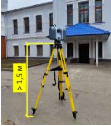
Рис. 4. Мінімальна висота триноги для визначення стану дорожнього покриття
