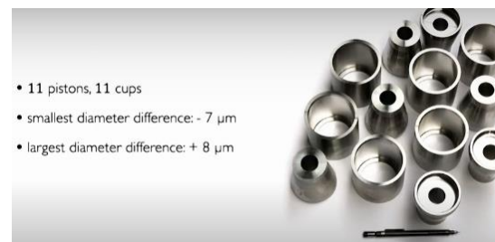
Рис. 5. Параметри поршневих пар гідромашин Innas: 11 поршнів з максимальним зазором 7 мкм і натягом до 8 мкм
