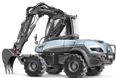
Рис. 3. Екскаватор Mecalac з електричним приводом ходового й робочого обладнання
