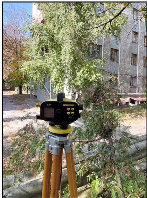
Рис. 2. Електронний нівелір Leica Sprinter 100M для дослідження осідань гуртожитку ХНАДУ №5 Leica Sprinter призначений для будівельно-
